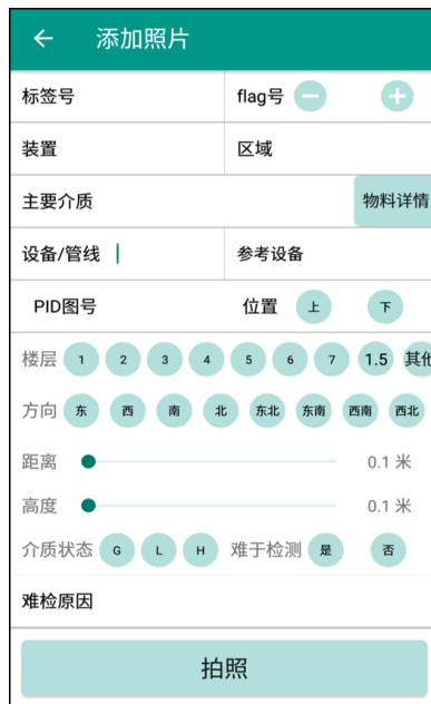
图 3.2.4-1 现场建档时手操器界面示例
